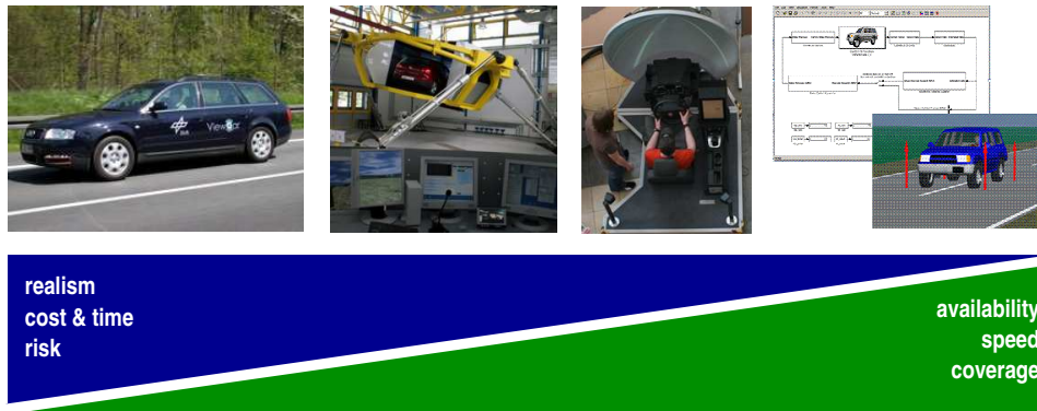
Abbildung 1. Verschiedene Formen der Assistenzsystemerprobung: Versuchsfahrt, simulierte Versuchsfahrt im beweglichen bzw. starren Fahrersimulator, modellbasierte simulierte Versuchsfahrt (v.l.n.r.)
